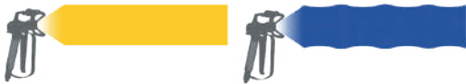
Рис.: При низком давлении: равномерное распыление мембранного насоса (желтый) и неравномерное распыление поршневого насоса (голубой).
